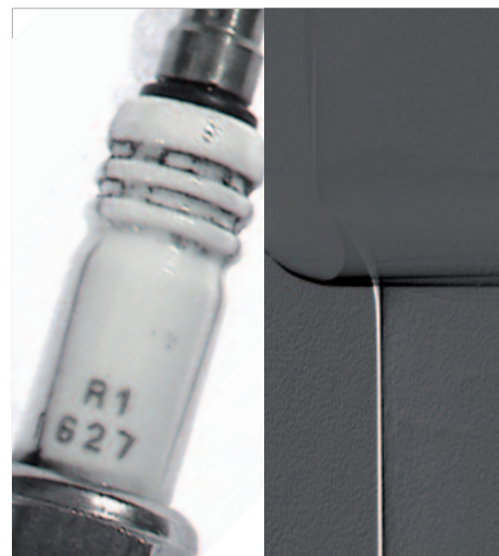
Ρωγμή κεραμικού στο μονωτήρα μπουζί (αριστερά ολόκληρο το μπουζί, δεξιά τμήμα σε μεγέθυνση).
