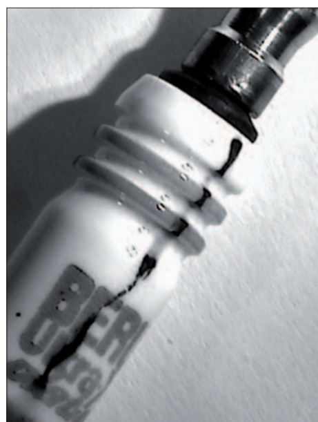
Αποτυχίες ανάφλεξης; Αιτία είναι συνήθως μια βλάβη του συνδετήρα μπουζί.
