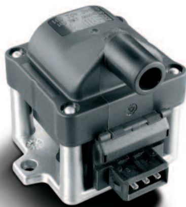
Πολλαπλασιαστής τύπου μπλοκ BERU με ενσωματωμένη τελική βαθμίδα για περιστροφική διανομή υψηλής τάσης σε μοντέλα της VW και της Audi.
