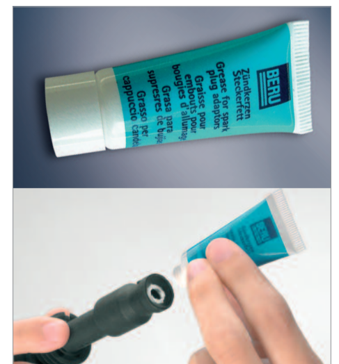
Λιπαντικό για μπουζί σπινθήρα BERU: Επάλειψη στο εσωτερικό του συνδετήρα πριν βιδώσετε το μπουζί το λιπαντικό προστατεύει από την ευθρυπτότητα και κατά συνέπεια από τη δημιουργία τόξων λόγω υπερτάσεων (αρ. παραγγελίας BERU 0 890 300 029).
