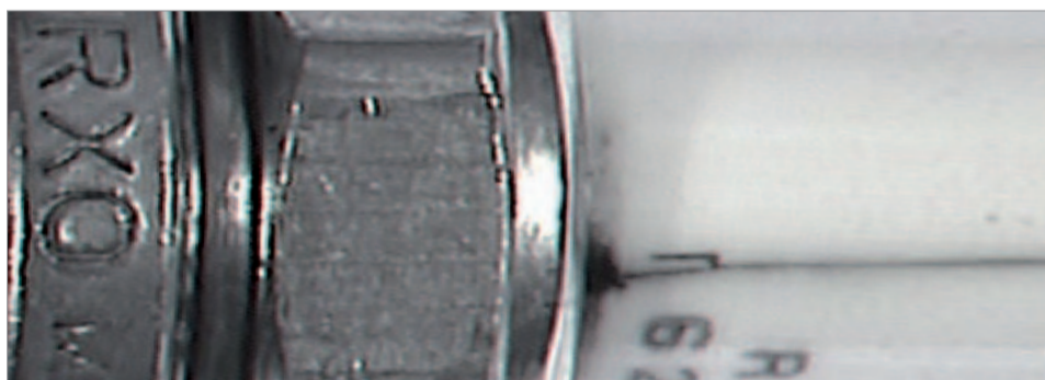
Μονωτήρας μπουζί, που έχει υποστεί βλάβη λόγω ηλεκτρικών τόξων που οφείλονται σε υπερτάσεις.
