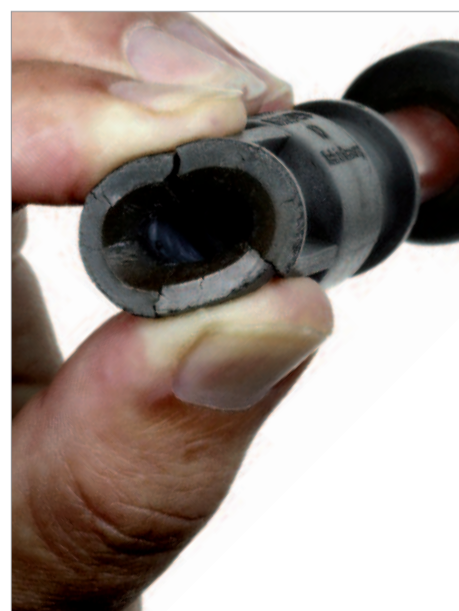
Ένας εύθρυπτος συνδετήρας μπουζί με λεπτές ρωγμές (διακρίνεται καθαρά με συμπίεση).
